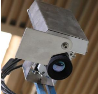
Abbildung 17: Shutter offen Kamera
